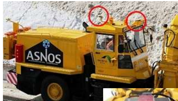
2つのCLASアンテナ(赤丸部分)で取得した位置情報をもとに方向を検出
