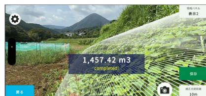
体積計測（GNSS-RTK）
