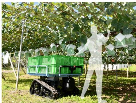
圃場内の作業者を自動追従する運搬車『フォロン』は、果樹等の収穫及び運搬において、身体的負担を軽減するだけでなく、収穫物をコンテナに入れるための往復や、コンテナを一輪車で運ぶ等の労働時間を削減することを目指しています。
