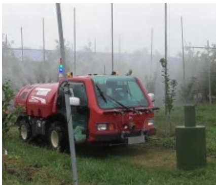
標準障害物を用いた 前方障害物検知試験
