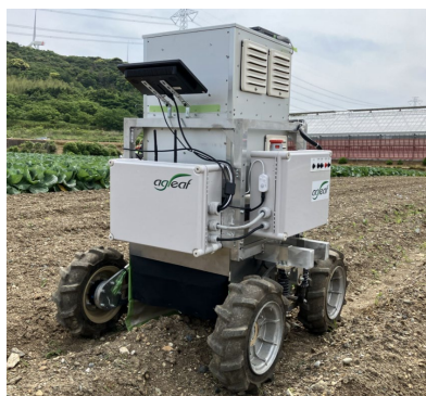
開発中のレーザー除草ロボット
