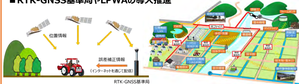
RTK-GNSS基準局の導入
