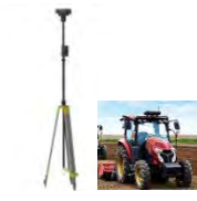
ロボットトラクター + RTK基準局
