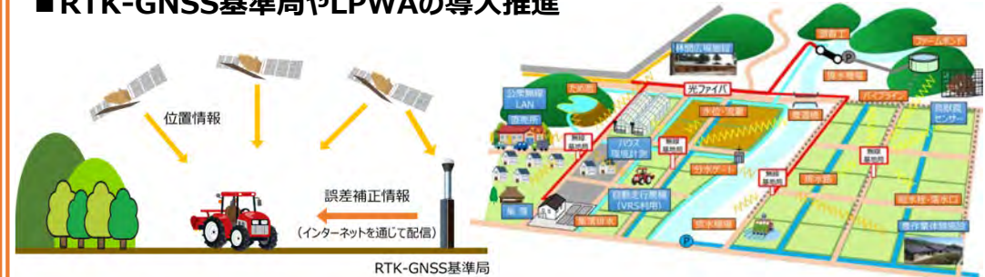
RTK-GNSS基準局の導入
