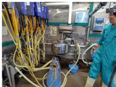
洗浄後の乳量計付自動離脱装置
