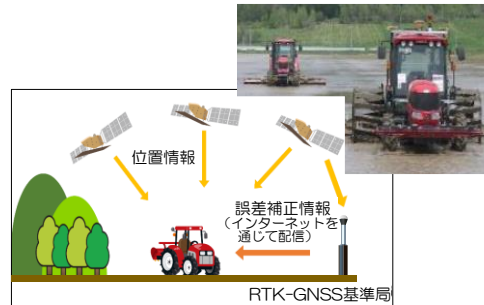
RTK-GNSS基準局の設置により衛星測位 データを補正し、自動走行の精度を向上
