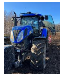
位置補正情報を利用した自動操舵農機
