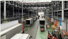
全天候型で、左右どちらにも荷下ろし可能な中央通路
