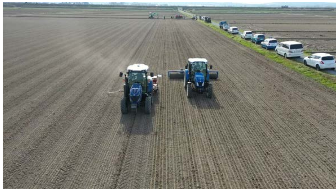
高速汎用播種機にて直播 ニコトリンブルFM750 RTKGPS自動操舵システム利用
