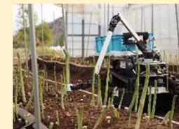
アスパラガスの収穫量に応じた自動収穫ロボットサービス
