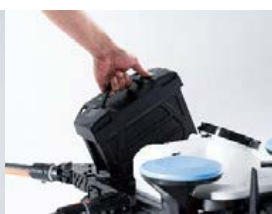
折りたためる構造、バッテリー・タンク交換はスムーズ
