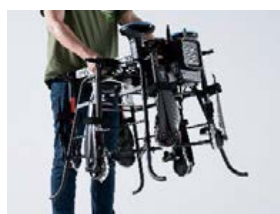
折りたためる構造、バッテリー・タンク交換はスムーズ
