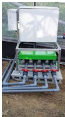
遠隔自動灌水システム「web-ドリッパー」
