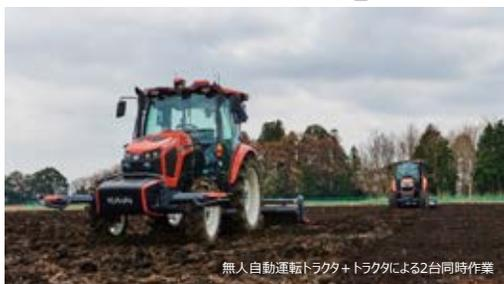
無人自動運転トラクタ+トラクタによる2台同時作業
