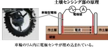
車輪のリム内に電極センサが埋め込まれている。
