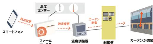
従来の温度調整器・制御盤にファームボックスを接続することで、遠隔からカーテンの開閉温度の調整などの操作を実行できるようになります。
