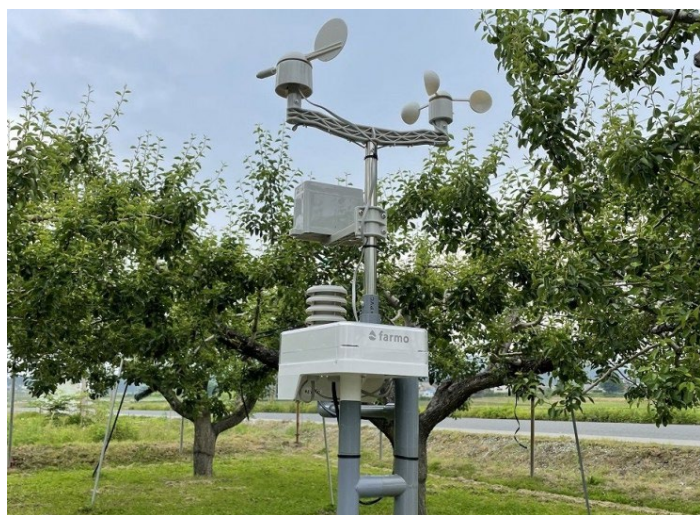
圃場に設置された気象センサー
