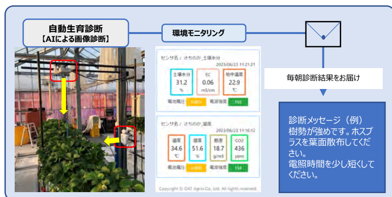
AI画像診断の仕組み
