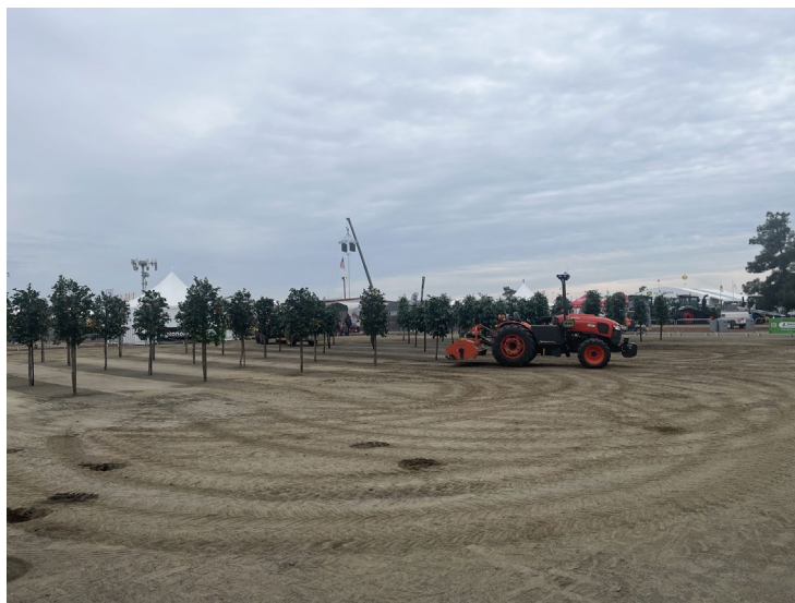
↑クボタの園芸作物用トラクターに米国スタートアップ Agtonomy 社のスタートアップが開発した自動運転技術を搭載（NRI 撮影）
