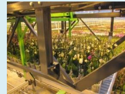
鉢物の自動搬出システム (オランダの例)
