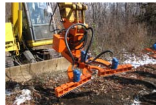
育林作業用自動植付機、自動下刈機 を導入し、植え付け、下刈作業の効率化を実証
