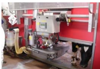
精密な栄養管理や病気の早期発見ができる 自動搾乳・給餌システム の開発
