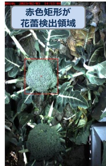
AIによる花蕾の検出と大きさの計測により収穫判断が可能となるほか、花蕾を傷つけることなく外葉を切断し、収穫物を自動で回収
