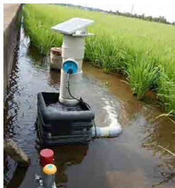
写真1 給水バルブに設置した電動アクチュエータ
