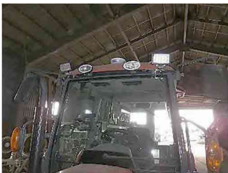
GNSSガイダンスシステム装着トラクター
