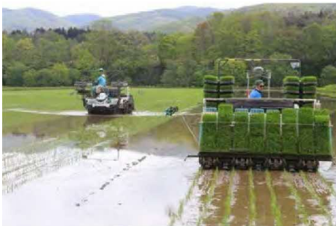
GNSSガイダンス及び自動操舵による田植え 未経験者によるオペレーターが可能に
