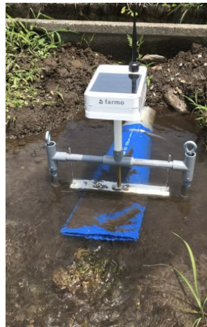
自動給水ゲート
