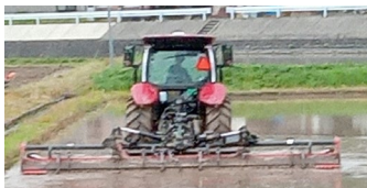
GPS機能付トラクターを使った代かき作業
