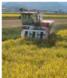
営農支援システム 食味・収量コンバイン （左：収穫作業、右：食味・収量の測定結果）
