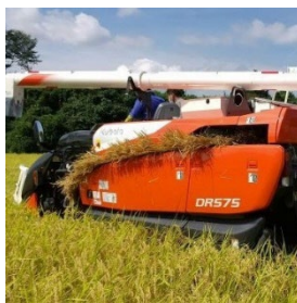
コンバイン（収穫 時に水分・収量・ 食味を測定）
