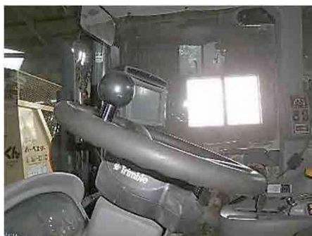
GNSSガイダンスシステム装着トラクター
