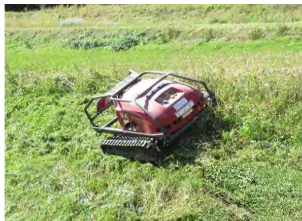
作動中の ラジコン草刈機
