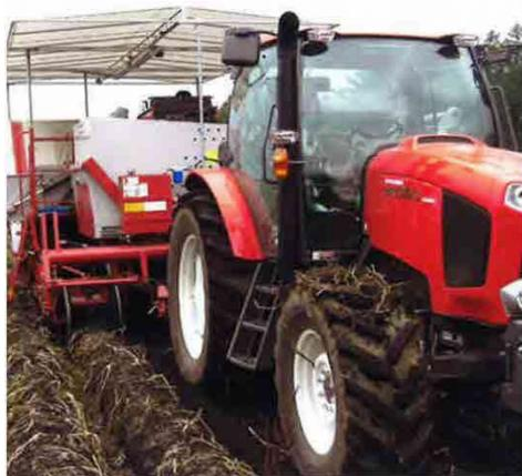
●GNSS自動操舵装置装着トラクター
