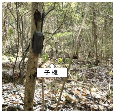
写真1 広域型罾センサー通信装置の設置状況
