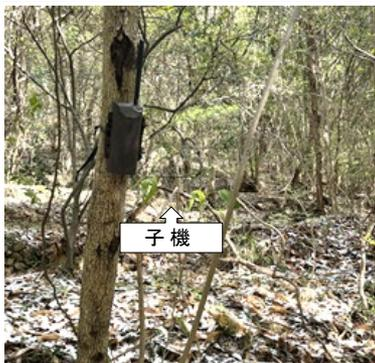
写真1 広域型罾センサー通信装置の設置状況
