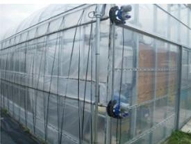
写真2 自動換気装置
