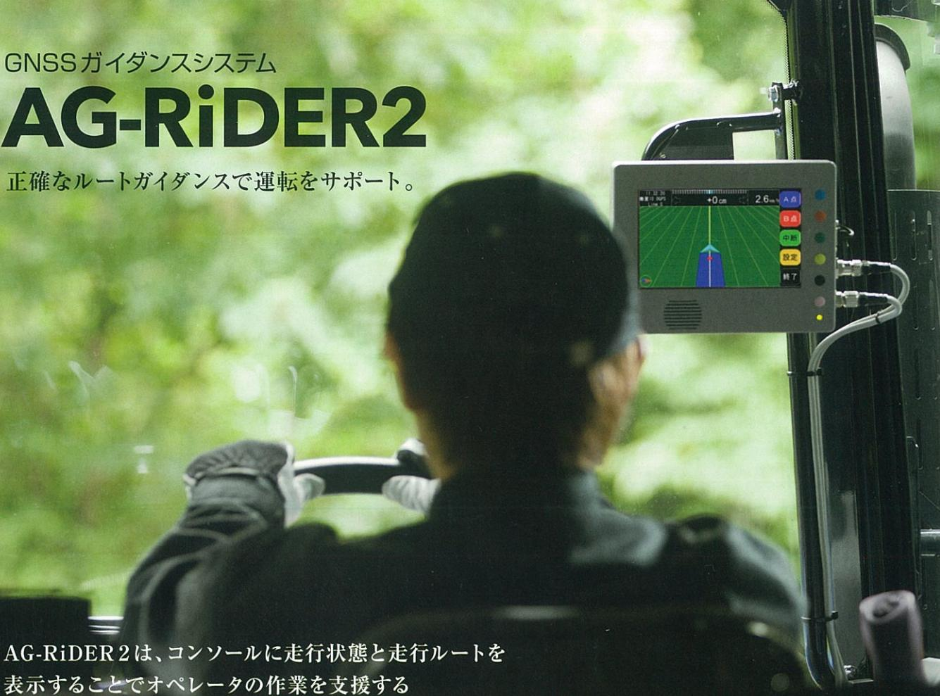
AG-RIDER2は、コンソールに走行状態と走行ルートを表示することでオペレータの作業を支援するガイダンスシステムです。表示に従ってハンドル操作を行うだけで無駄の無い正確な作業が実現できます。
