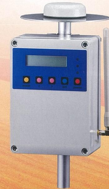
圃場のそばにRTK基地局を設置することでGPSの誤差を補正し、±3cmの位置精度でトラクタの直線走行を維持します。畠の間隔を精密に均一化することにより、作物の育成中にトラクタで行う除草や施肥の際に、誤って作物を刈り取ってしまったり、作物を踏みつけてしまうなどといったトラブルを未然に防ぎます。
