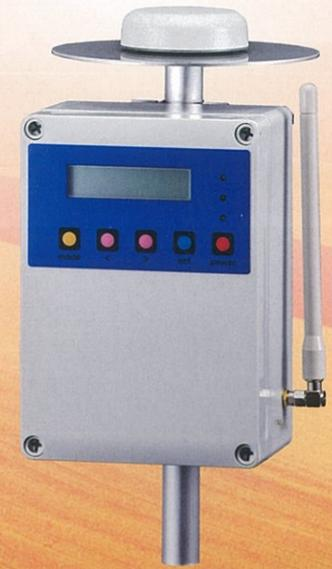
圃場のそばにRTK基地局を設置することでGPSの誤差を補正し、±3cmの位置精度でトラクタの直線走行を維持します。畝の間隔を精密に均一化することにより、作物の育成中にトラクタで行う除草や施肥の際に、誤って作物を刈り取ってしまったたり、作物を踏みつけてしまうなどといったトラブルを未然に防ぎます。
