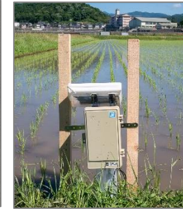
センシングデータ送信 LPWA(LoRaWAN)通信
