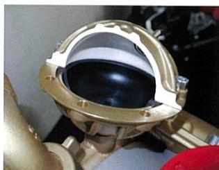
チャンバー内の一定の圧力(0.3~0.4MPa)によりチャンバーゴムが作用し、ポンプの脈動を最小限に抑えます。
