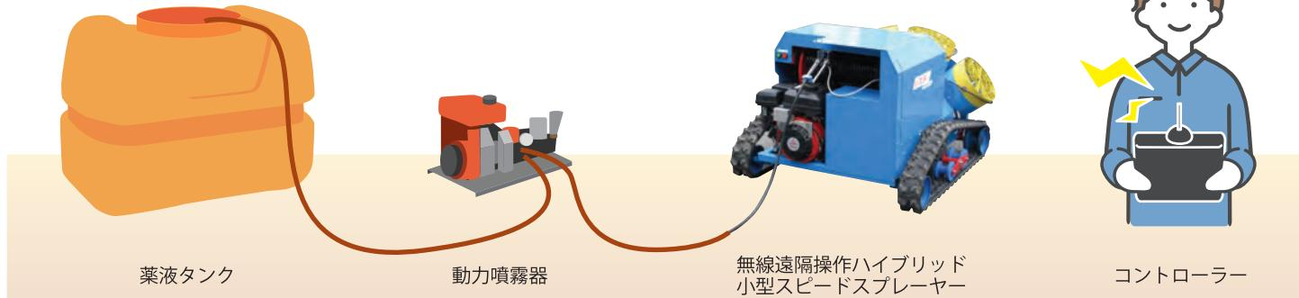
薬液タンク・動噴・無線遠隔操作ハイブリッド小型スピードスプレーヤーを繋げるだけ！
