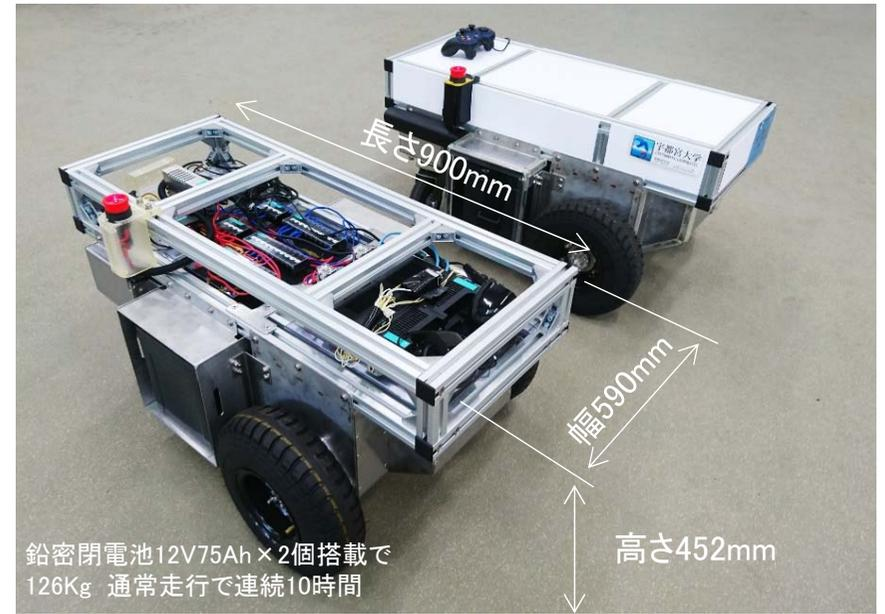
移動ロボット(ベース車両) 駆動モータ200W x 2輪。速度比1/30のときで1.6m/s(5.7km/h)。マウントレールに様々なツールが接続可能。
