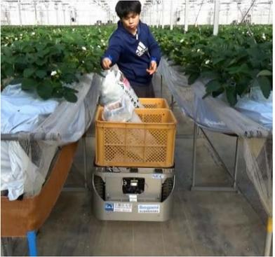
左図は、はがき作業中での支援作業の様子。ロボットは作業者に追従して走行し、作業者の指示によって集積場まで移動する。
