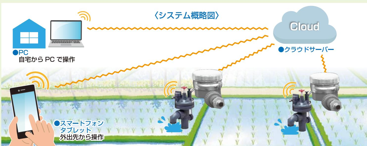
新開発の「IoT デバイス」装置を、既存の自動給水栓のフロートタイプのセンサーと交換するだけで遠隔地からの給水バルブの開閉が可能になります。電源は不要で、デバイス装置に付けられたソーラーパネルからの電力のみで給水栓を開閉することができます。
