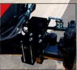
フロントアクスル上部に取り付けたセンサで、操舵アシスト時の前輪の切れ角を検出します。
