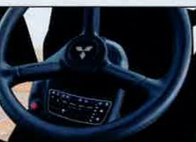
カメラ映像からの操舵指示を受け、内蔵のモータで操舵をアシストします。ステッピングモータ採用により、超低速時でも安定した制御が可能です。
