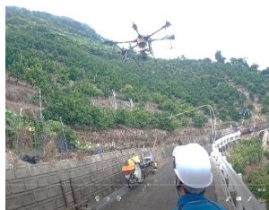
中山間地における自動飛行による 柑橘ドローン防除
