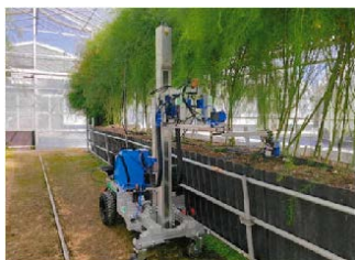
アスパラガス収穫ロボットによる収穫の様子
