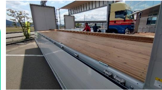
県産材を活用したトラック床材
