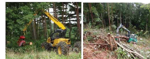
集材を行うハイランダー (ホイール式ハーベスタ) 運材を行うグレモ (ホイール式フォワーダ)
