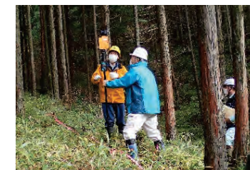
【現地検討会の様子】 3Dレーザースキャナ による収穫調査
