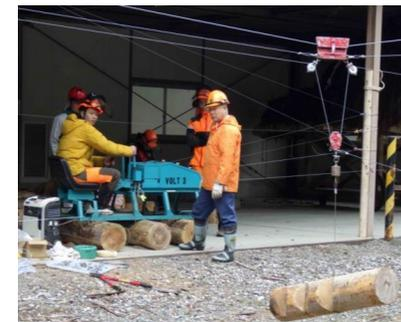
【南予森林アカデミーでのミニ集材機による架線集材技術の実習】
