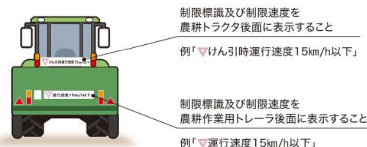
図2-4-7 傾斜角一定以下、ブレーキ未装備トレーラーに必要な表示
