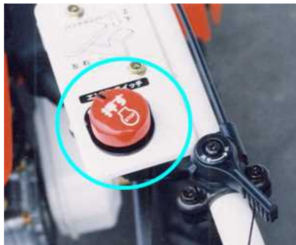
緊急停止ボタン
