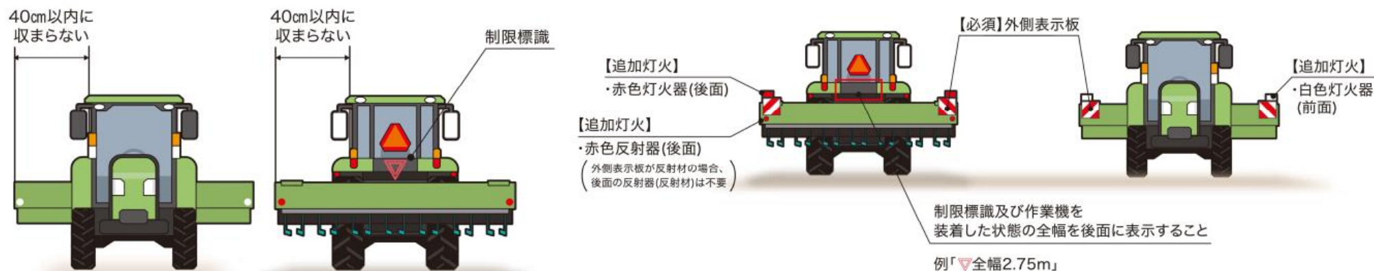
図2-4-5 幅が2.5mを超える場合はゼブラマークと制限標識・全幅の表示
