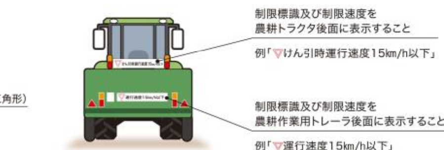
図2-4-7 傾斜角一定以下、ブレーキ未装備トレーラーに必要な表示
