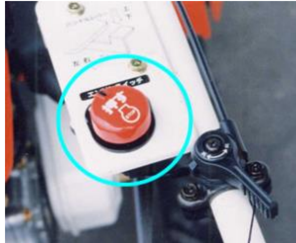
緊急停止ボタン
