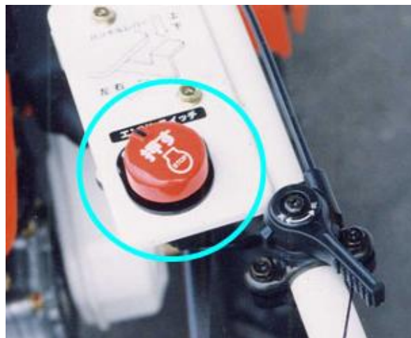
緊急停止ボタン
