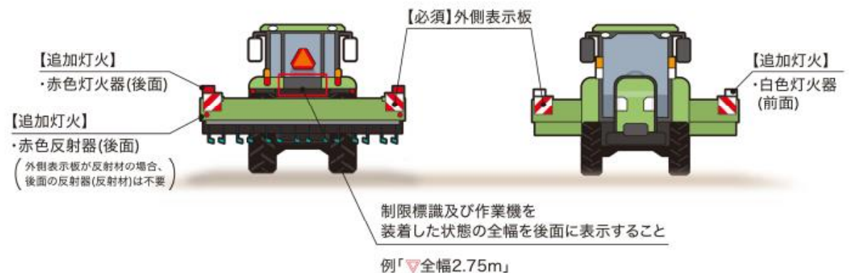
図2-4-5 幅が2.5mを超える場合はゼブラマークと制限標識・全幅の表示
