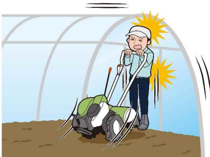
後退時に支柱等に挟まれる
