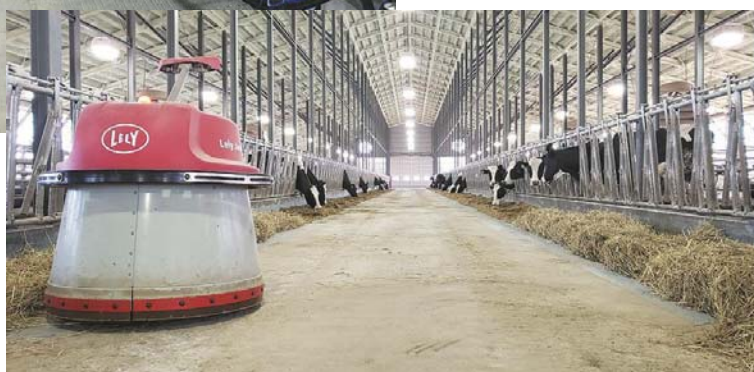
＜新牛舎に導入した餌寄せロボット＞ 人手による1日3回の餌寄せ作業を自動化。
