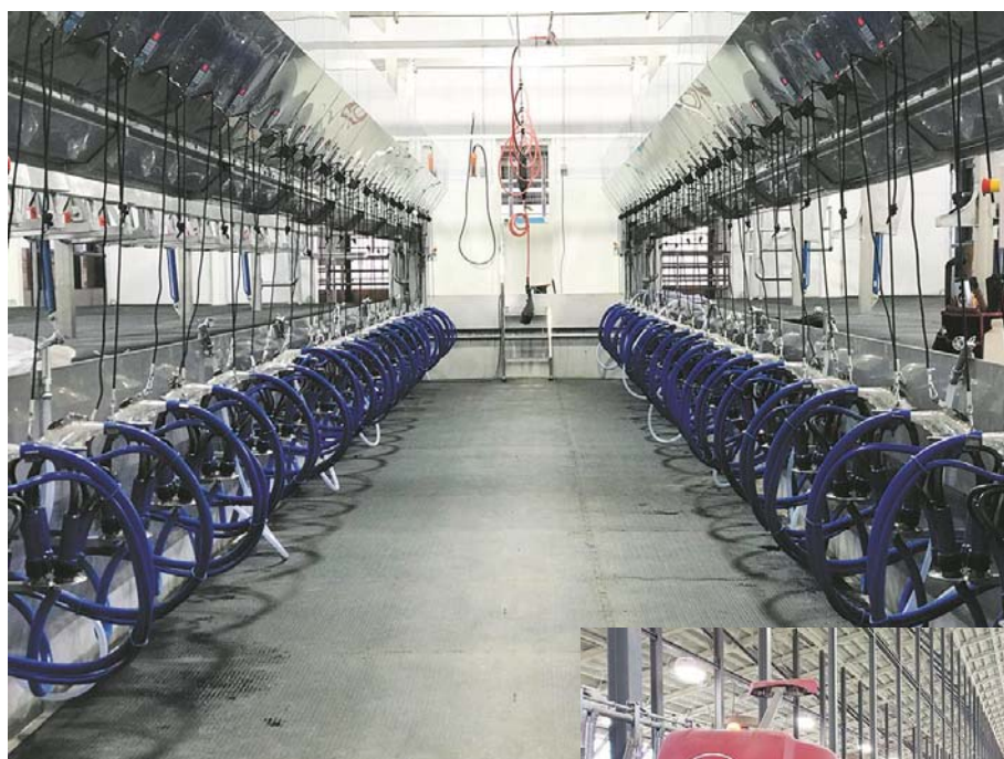
＜新牛舎に導入したミルクングパーラー＞ 大規模な牛群を効率よく搾乳できる パラレルパーラーを採用。
