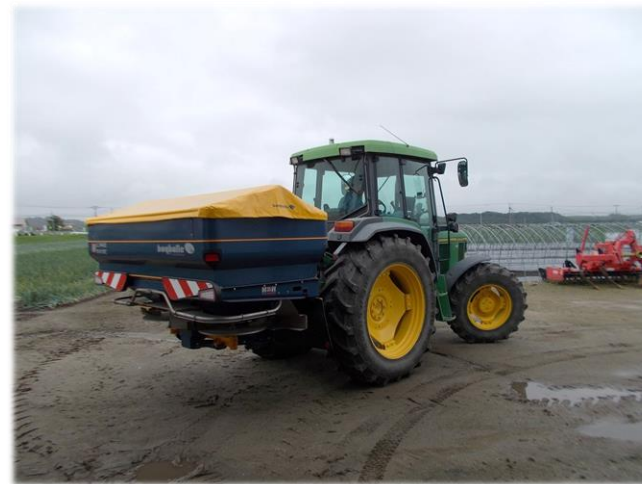
GPS機能付き肥料散布機を搭載したトラクター
