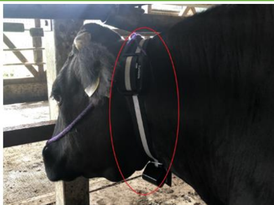
▲牛の首へ取り付けしたセンサー
